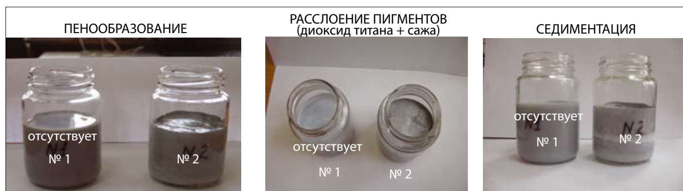
Рис. 2. Сравнение качества пигментных паст, полученных в присутствии разных стабилизирующих систем. Паста №1: Лакротэн Э-245 (7,5%) + диспергатор (0,2%); паста №2: диспергатор (1,0%)
